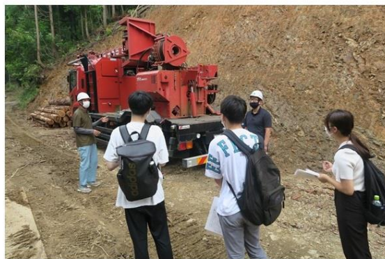
↑ オーストラリア製タワーヤーダーでワイヤを張って木材を収集
