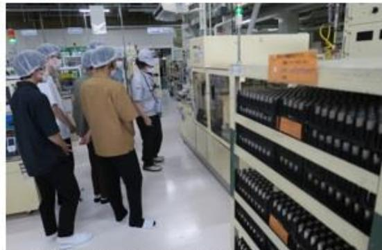
電池電圧を安定電位まで放電させる予備放電工程
